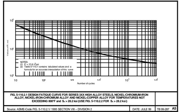
Fig. 15 Low cycle Diagramm
