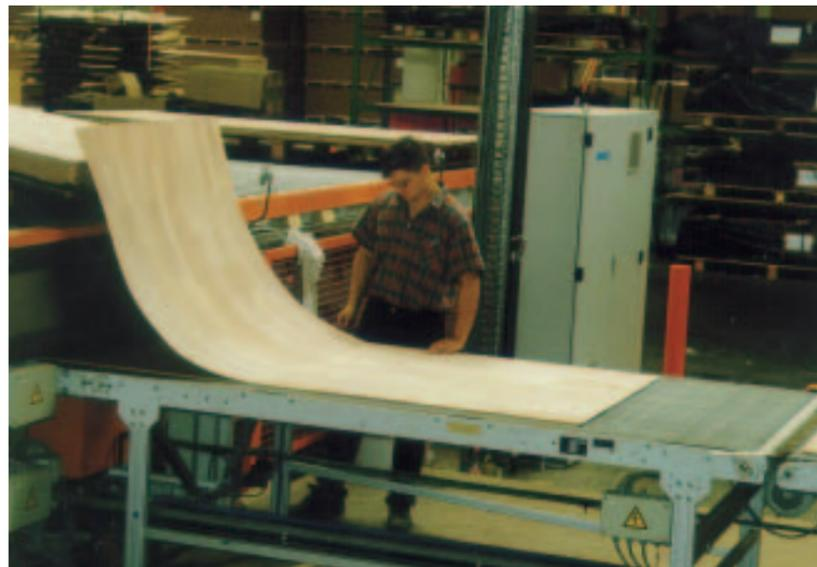
Manuelles Legen des oberen und unteren Furniers, automatisches Ablegen der beleimten Trägerplatte
